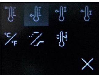
Mit den beiden Tastern ① und ② können Sie sich im Menü bewegen. Die aktuelle Funktion wird grau hinterlegt, nach Betätigen des Tasters ③ öffnet das Eingabefenster in dem dann der entsprechende Vorgabewert eingestellt werden kann.
