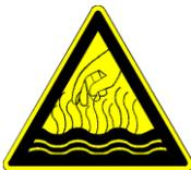
Achtung! Vor Arbeiten am Gerät bei Instandsetzungs- und Reinigungstätigkeiten das Wasserbad abkühlen lassen! Das Wasser im Bassin kann bei Bedarf über den Entleerungshahn an der Rückseite auch abgelassen werden.
