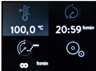
Mit den Tastern ① und ② können Sie sich im Menü bewegen. Die aktuell angesprochene Funktion wird grau hinterlegt und ist mit dem Taster ③ zu öffnen. Entsprechen die gespeicherten Sollwerte unter den Funktionssymbolen Ihren Prozessanforderungen, kann das Wasserbad durch Betätigen von Taster ④ (3 Sekunden gedrückt halten) gestartet und durch erneutes Betätigen des Tasters ④ (kurz) wieder abgeschaltet werden.
