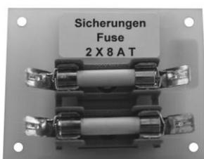
In unmittelbarer Nähe der Verschraubung des Zuleitungskabels befinden sich im Inneren des Wasserbades die Netzsicherungen F1 und F2 (siehe Kapitel 13) auf einem Sicherungsträger. Zur Überprüfung und zum Austausch muss das Bodenblech des Wasserbades demontiert werden. Die Sicherungen dürfen nur gegen baugleiche Sicherungen ausgetauscht werden. Informationen über den eingesetzten Sicherungstyp finden Sie auf einem Schild neben den Sicherungen und in der Ersatzteilliste.
