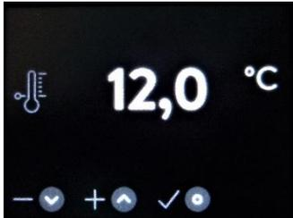
Der maximale Sollwert ist von 10,9 °C bis 100 °C, der minimale Sollwert von 10,0 °C bis 99,1 °C begrenzbare. Die einstellbaren Werte beider Funktionen sind gegeneinander verriegelt. Die maximale Begrenzung der Solltemperatur ist nicht kleiner als die minimale Begrenzung einstellbar und umgekehrt.
