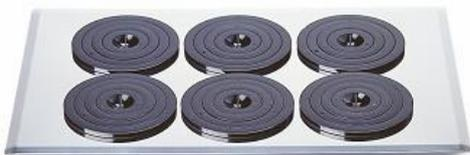
Lochdeckel aus „Edelstahl-Rostfrei“ mit 6 Ringsätzen (4-teilig) aus wärmebeständigem Kunststoff, Öffnungen Ø 91 mm, zwischen 90 und 50 mm in 20 mm Schritten zu verkleinern. Erhöht die Variabilität des Wasserbades und verringert den Wärmeverlust beim Einstellen hoher Gefäße. Für Hydro H 16, H 16 A und H 22.
