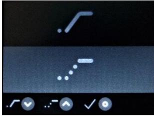
Mit den Tastern ① und ② kann zwischen beiden Startoptionen umgeschaltet werden, die angesprochene Option wird grau hinterlegt und ist mit dem Taster ③ zu bestätigen. Die Displayanzeige schaltet in das Menü Grundeinstellungen zurück. Das Symbol der ausgewählten Startoption wird in den Einstell- und Anzeigefenstern immer zusammen mit dem Symbol der Betriebszeit dargestellt.
