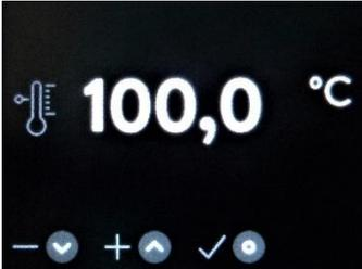
Mit den beiden Tastern ① und ② können Sie den gewünschten Temperaturwert einstellen und im Anschluss mit Taster ③ den eingestellten Wert bestätigen und ins Hauptmenü zurückschalten. Der eingestellte Sollwert wird unter dem Temperatursymbol im Hauptmenü angezeigt.
