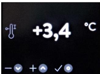
Der Schaltpunkt für den Übertemperaturalarm ist zwischen 0,0 K und +10,0 K oberhalb des Temperatur Sollwertes einstellbar. Für den Untertemperaturalarm ist ein Wert zwischen 0,0 K und -10,0 K festlegbar. Nur bei prozessbedingter Notwendigkeit sollte der Wert für den Untertemperaturalarm kleiner als -4,0 K und für den Übertemperaturalarm kleiner als +2,0 K eingestellt werden.
